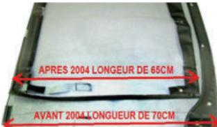
*Jimny 2 modèles de toit*
